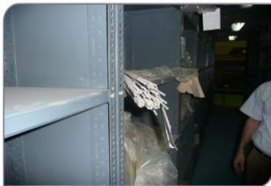
شکل ۱۱-۴. بیرون زدگی میل گرد ها از روی قفسه
