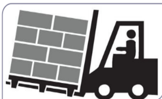
شکل ۵-۱۷. چگونگی قرارگیری شاخک لیفتراک زیر پالت
