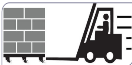
شکل ۵-۱۸. عدم هل دادن پالت با استفاده از شاخک لیفتراک
